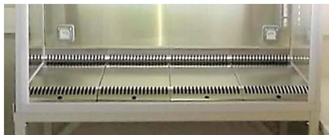
Le plan de travail en inox 316L est sécable. Ce système permet le retrait des segments pour le nettoyage et pour une éventuelle stérilisation.
